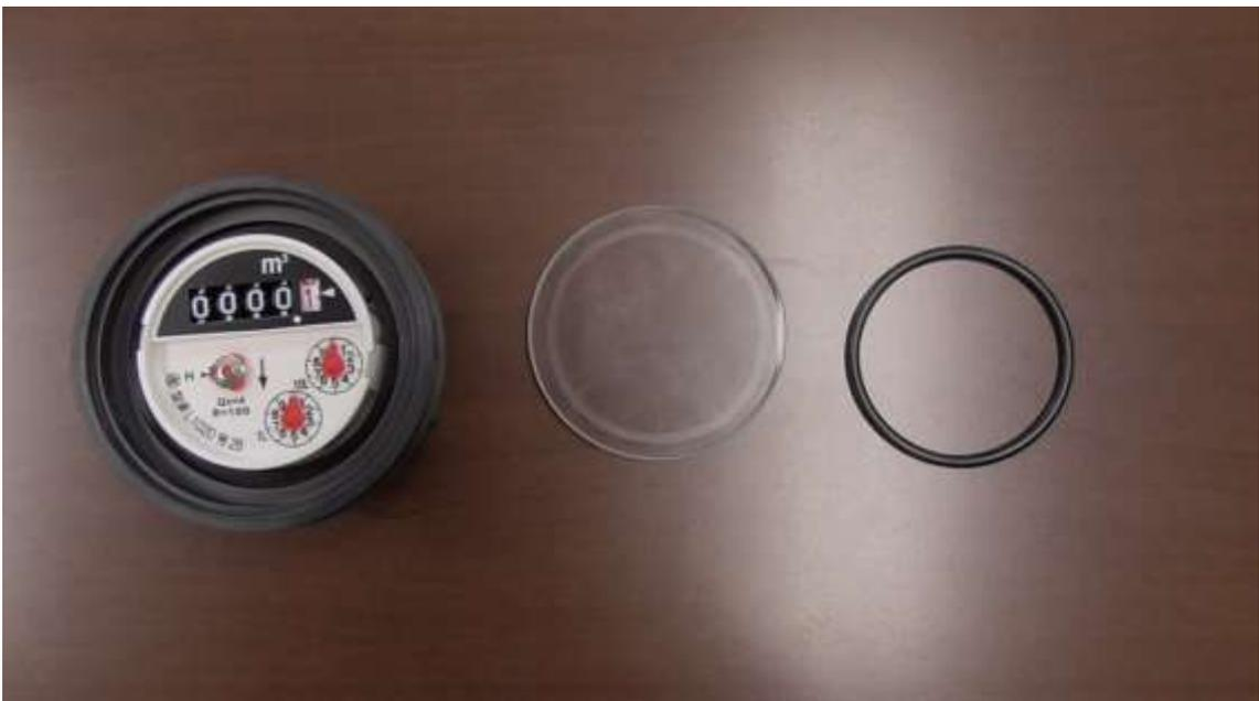
写真 10 本件被告ら物件の流量計用指針ユニット分解写真
