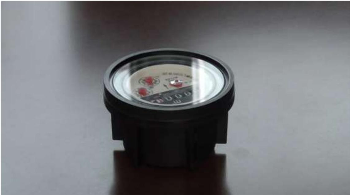
写真 9 本件被告ら物件の流量計用指針ユニット斜視写真
