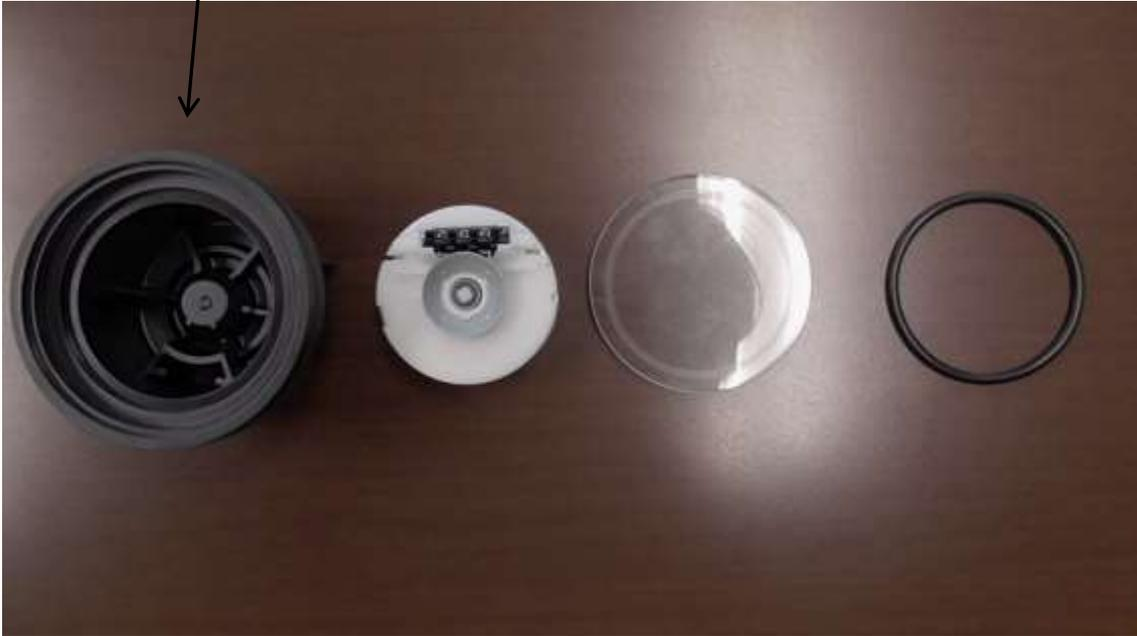
写真 1 1 本件被告ら物件の流量計用指針ユニット分解写真
