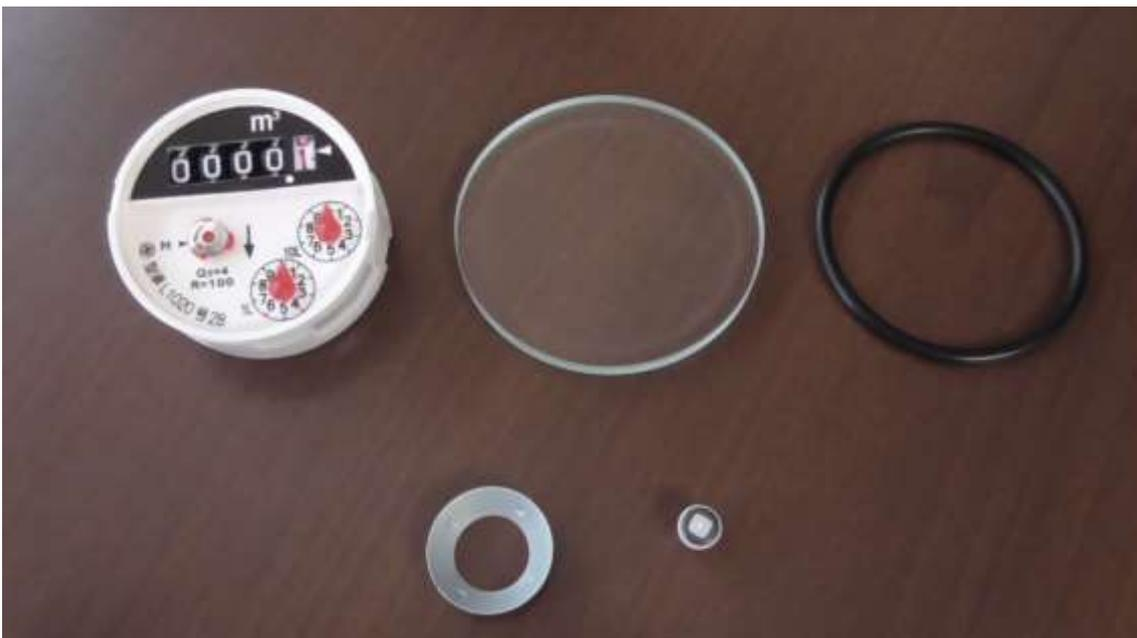
写真14 本件被告ら物件の流量計用指針ユニット分解写真
