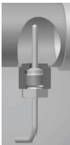
図 4 位置に依存しない設置は、正確な温度測定を単純化する
