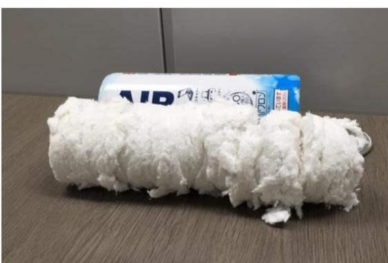
(4) 被告製品 4 及び 5 は，上記スプレー缶内の上記噴出口側において空間を有しており，且つ，スプレー缶内にスプレー缶と同じ円筒状に成形された上記吸収体を收容している。また，上記空間と上記吸収体の間には，上記吸収体の表面を通気可能に保護する蓋が配設されている。
