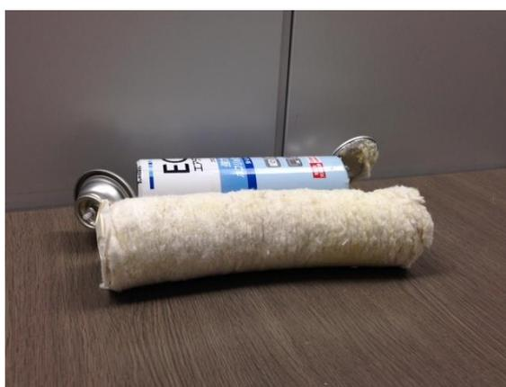
(4) 被告製品 3 は、上記スプレー缶内の上記噴出口側において空間を有しており、且つ、スプレー缶内にスプレー缶と同じ円筒状に成形された上記吸収体を收容している。また、上記空間と上記吸収体の間には、上記吸収体の表面を通気可能に保護する蓋が配設されている。
