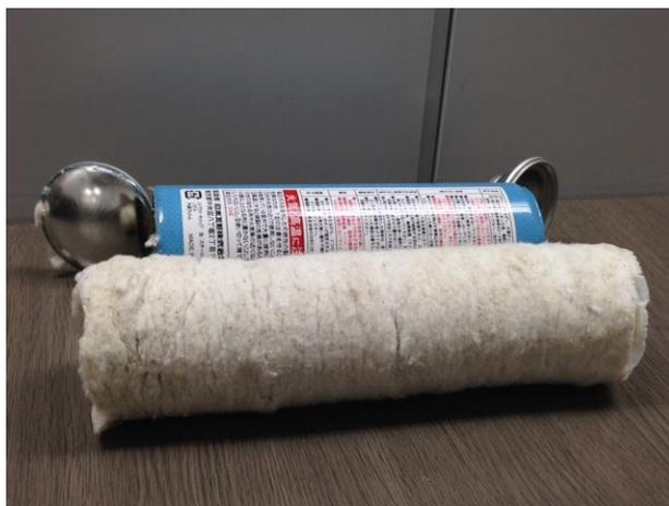
(4) 被告製品 2 は、上記スプレー缶内の上記噴出口側において空間を有しており、且つ、スプレー缶内にスプレー缶と同じ円筒状に成形された上記吸収体を收容している。また、上記空間と上記吸収体の間には、上記吸収体の表面を通気可能に保護する蓋が配設されている。
