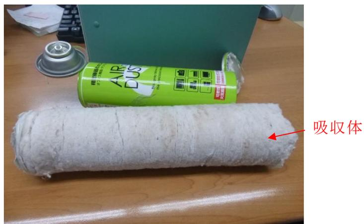
(4) 被告製品1は、上記スプレー缶内の上記噴出口側において空間を有しており、且つ、スプレー缶内にスプレー缶と同じ円筒状に成形された上記吸収体を收容している。また、上記空間と上記吸収体の間には、上記吸収体の表面を通気可能に保護する蓋が配設されている。
