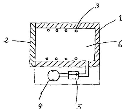
(エ) 「【図面の簡単な説明】 第 1 図は，本発明の一実施例に係る調理レンジの断面図である。1,2 ...レンジ本体としての外枠及び開閉扉，3 ...加熱手段としての発熱体，4 ...加減圧手段としてのポンプ，5 ...調圧器，6 ...レンジ室としての気密室。」( 4 欄 1 2 行目ないし 1 7 行目 )
