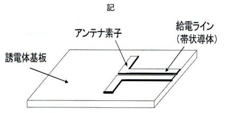
このアンテナは、誘電体基板に金属箔をエッチングして製作した ものである。誘電体基板はアンテナ性能に直接関わるものではなく、 帯状のアンテナ素子のための構造部材の役割を果たす。上記図に 「アンテナ素子」と記した構成が「パッチ」である。 また,引用発明は,プラスチックプリント基板の薄型化を図り, その結果,平面プリントアンテナ自体の薄型化を図ろうとするもの であるから,誘電体基板を厚手に形成することが必要条件であるマ イクロストリップアンテナと認定することはできない。
