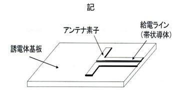
しかし、引用発明には、「パッチ型」として上記の構造が示されているものではなく、仮に上記のような「パッチ型」が一つの具体例として想定できるとしてもそれに限定されるものではない。しかも、上記ウに説示したとおり、平面プリントアンテナとしてのパッチ型の形態として、プリント基板上にマイクロストリップパッチを配したマイクロストリップアンテナが用いられ、パッチ型アンテナ又はパッチアンテナが、マイクロストリップアンテナに相当するものであることが、当業者にとって周知事項というのである。さらに、マイクロストリップアンテナとして本願補正発明が意図する構造(構成)に対しては、相違点1から3として認定した上、判断したところである。
