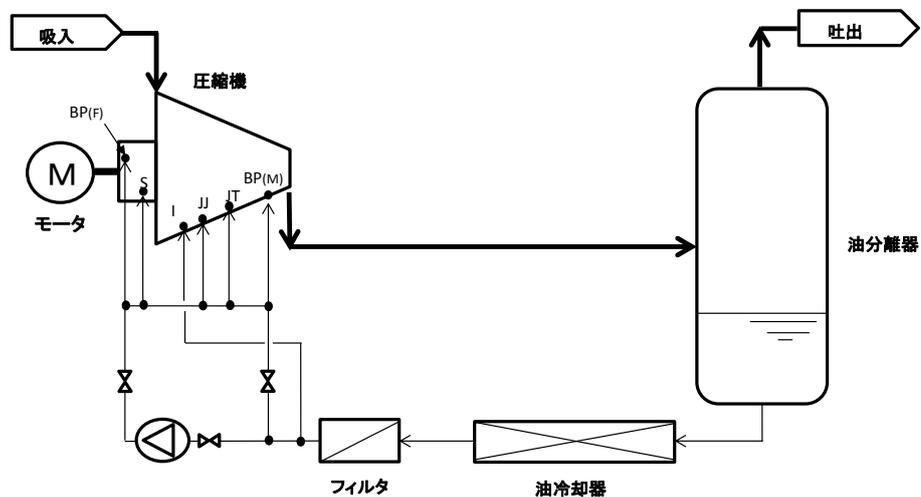
BP: バランスピストン、JT: スラスト軸受(M,F)、JJ: ラジアル軸受(M,F)、S: 軸シール、
