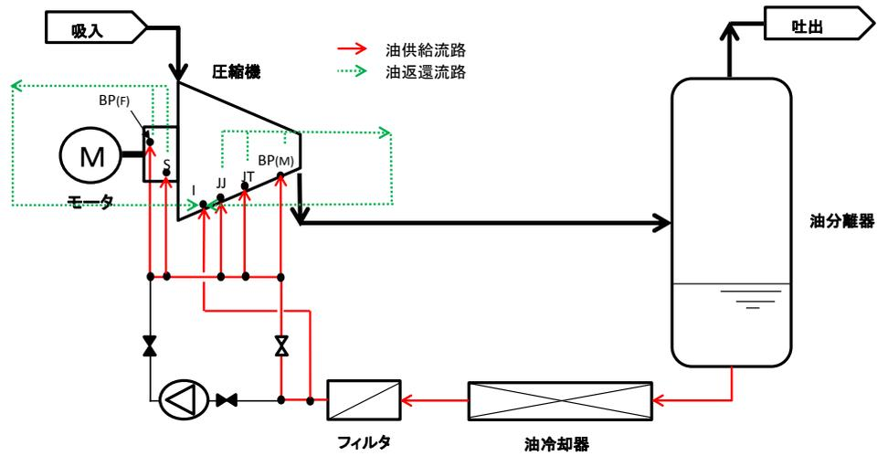
BP: バランスピストン、JT: スラスト軸受(M,F)、JJ: ラジアル軸受(M,F)、S: 軸シール、
