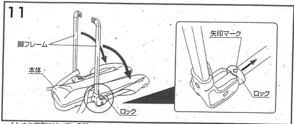
11. 本体両側に付いている脚フレームのロックを矢印マークの方向に外して、脚を折り畳んで下さい。
