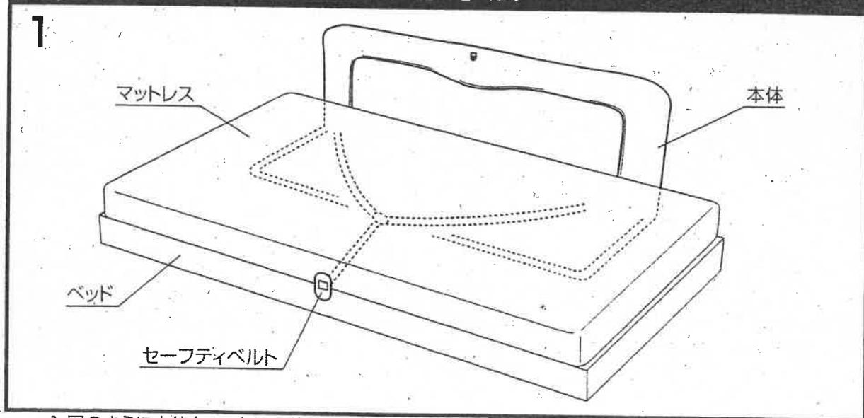
1. 図のように本体をマットレスとベッドの間にはさみ、反対側からセーフティベルトを出して下さい。
