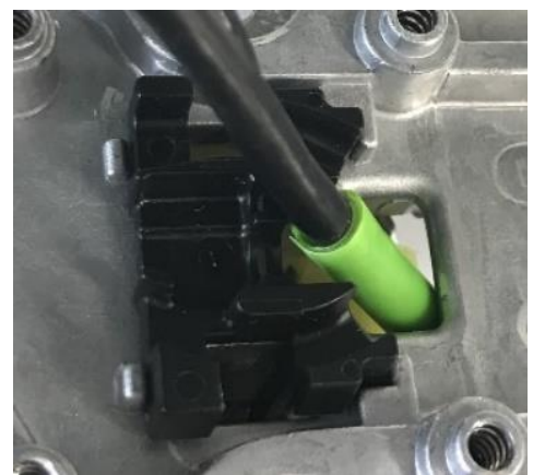
突出部の上面（アンプ基板側）を 塞ぐコの字型部材
