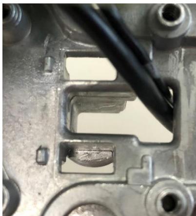
コの字型部材及びナットを外した 突出部の上面（アンプ基板側）
