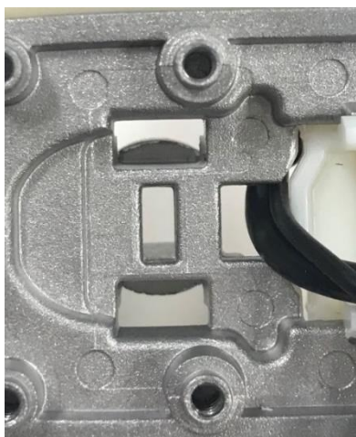
突出部の上面（アンプ基板側） を塞ぐ金属ベース
