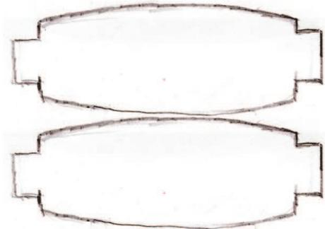
してみると、原告の主張とは逆に、「ロールの中央部からロールの縁部（両端）に向かって放物線状に直径が増加している」ような、ロールの中央部分がわずかに凹状に形成されたロールを用いることにより、均一な厚さ分布のフィルムが実現できることとなると解すべきである。
