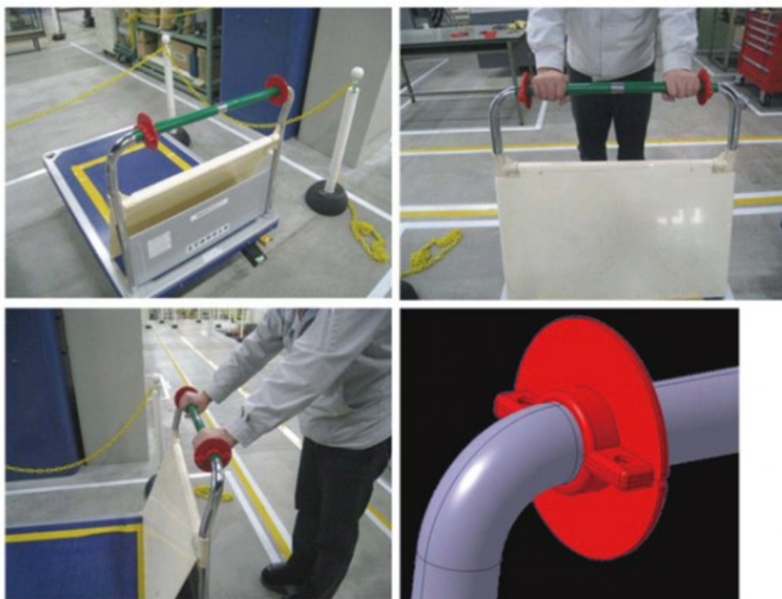
写真2 取っ手には鏝（つば）状のガードを付けて挟まれを防いだ
